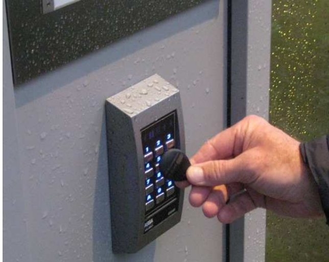
Åbning af yderdør med elektronisk nøgle
